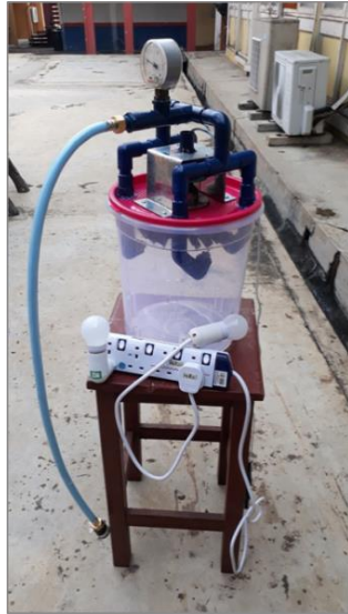
Rajah 5.2: Susun atur kit turbin hidro pico
