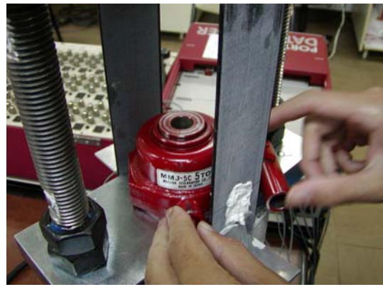
Fig 3.17 (d): Installing mini hydraulic pump onto lower mild steel plate
