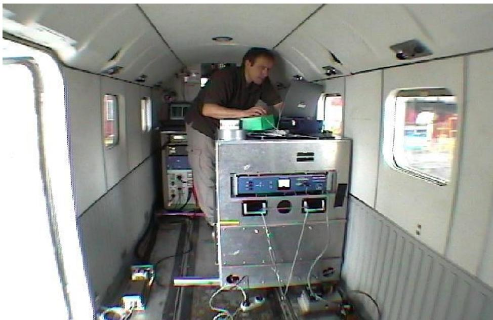
Pemasangan peralatan graviti di dalam pesawat
