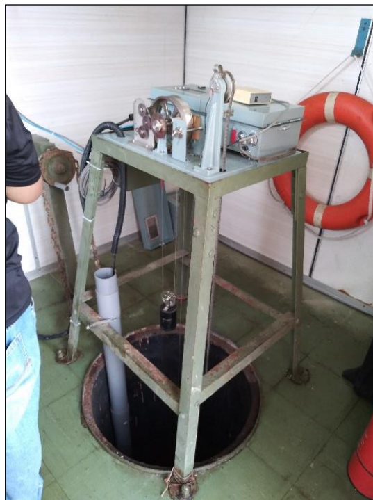
Rajah 4: Contoh peralatan Cerapan Air Pasang Surut Jenis Apungan
