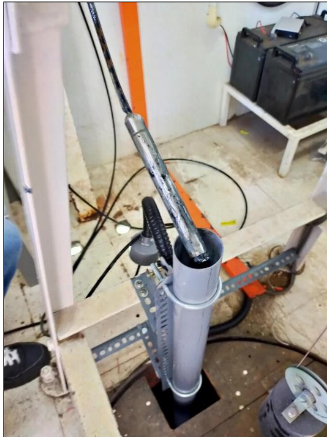
Rajah 5: Contoh peralatan Cerapan Air Pasang Surut Jenis Tekanan
