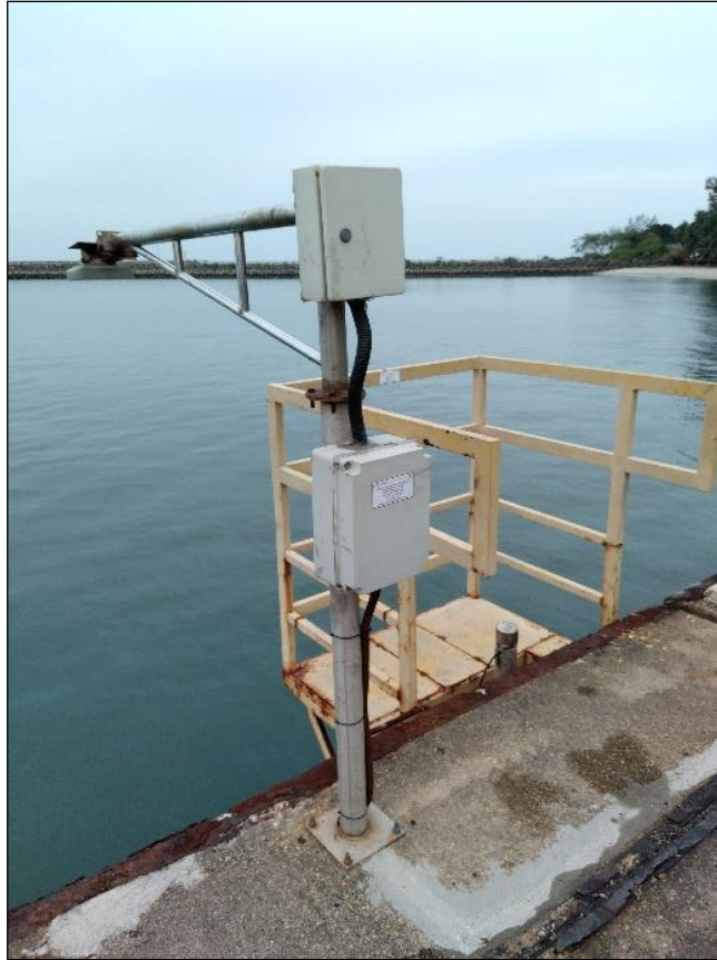
Rajah 6: Contoh peralatan Cerapan Air Pasang Surut Jenis Radar
